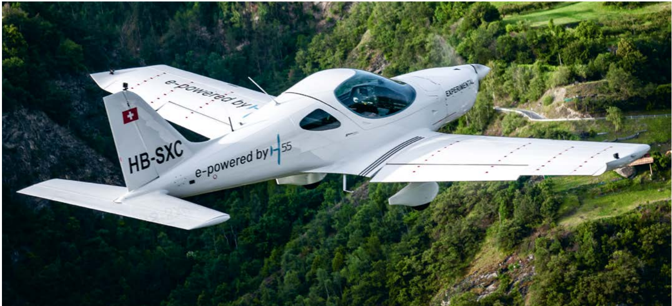
Foto Prototyp eines 100% elektrischen Flugzeugs von H55 © H55 Anna Pizzolante
